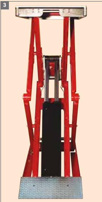
**3.** Sistema di livellamento idraulico delle due pedane, con doppio circuito master/slave (due cilindri per pedana), che consente la massima sicurezza di lavoro senza l'impiego di cremagliere meccaniche.
